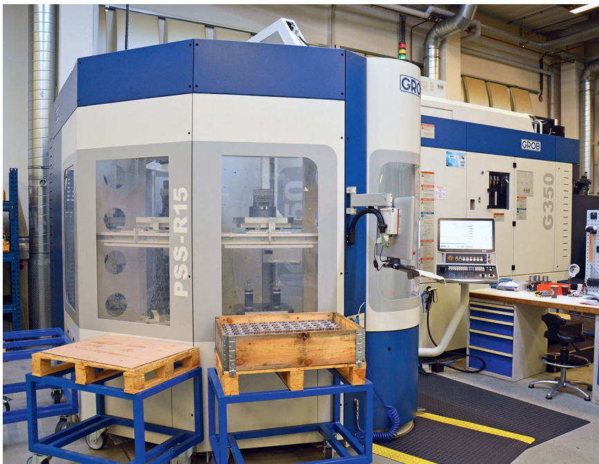
2 Bedienerlos durch die Nachtschicht: Die jüngste der drei Grob-Universal-5-Achs-BAZ bei EWS Weigele, eine G350, ist mit einem 15-fach-Palettenrundspeichersystem ausgestattet © Hanser
